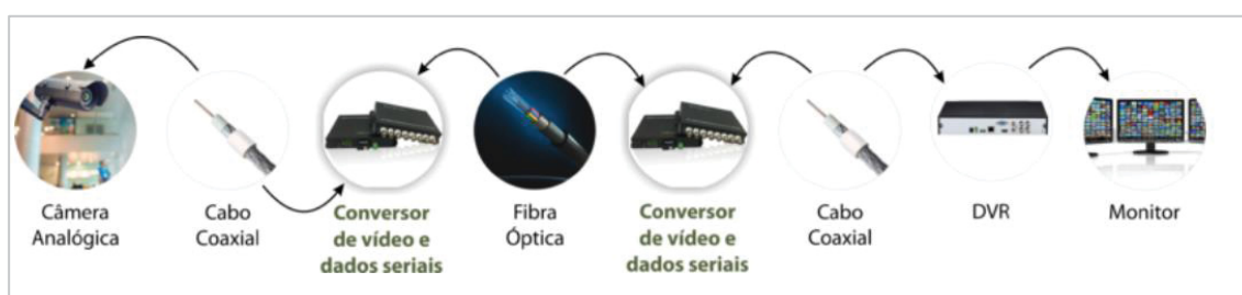
FIGURA 3 – ELEMENTOS DE INSTALAÇÃO DE CÂMERAS ANALÓGICAS
