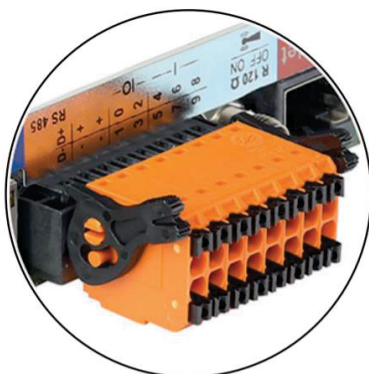
Figura 8 I/O Inversor Fronius
