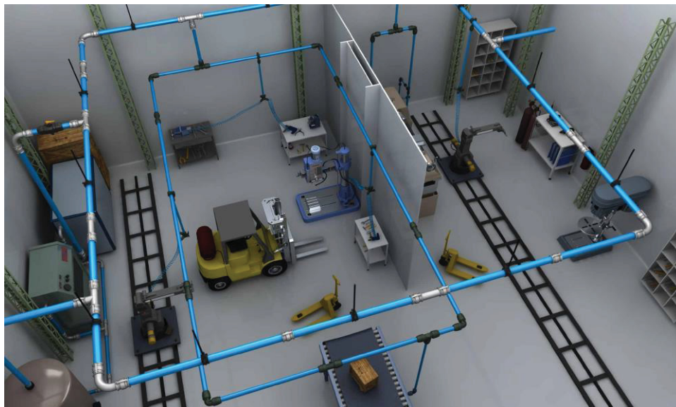
Figura 2 - Exemplo de rede industrial de ar comprimido
