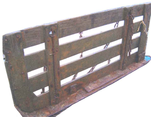
Figura 3 – Porta de madeira com base de ferro utilizada para manter a rede aberta quando submersa. Fonte: Natividade, 2005.
