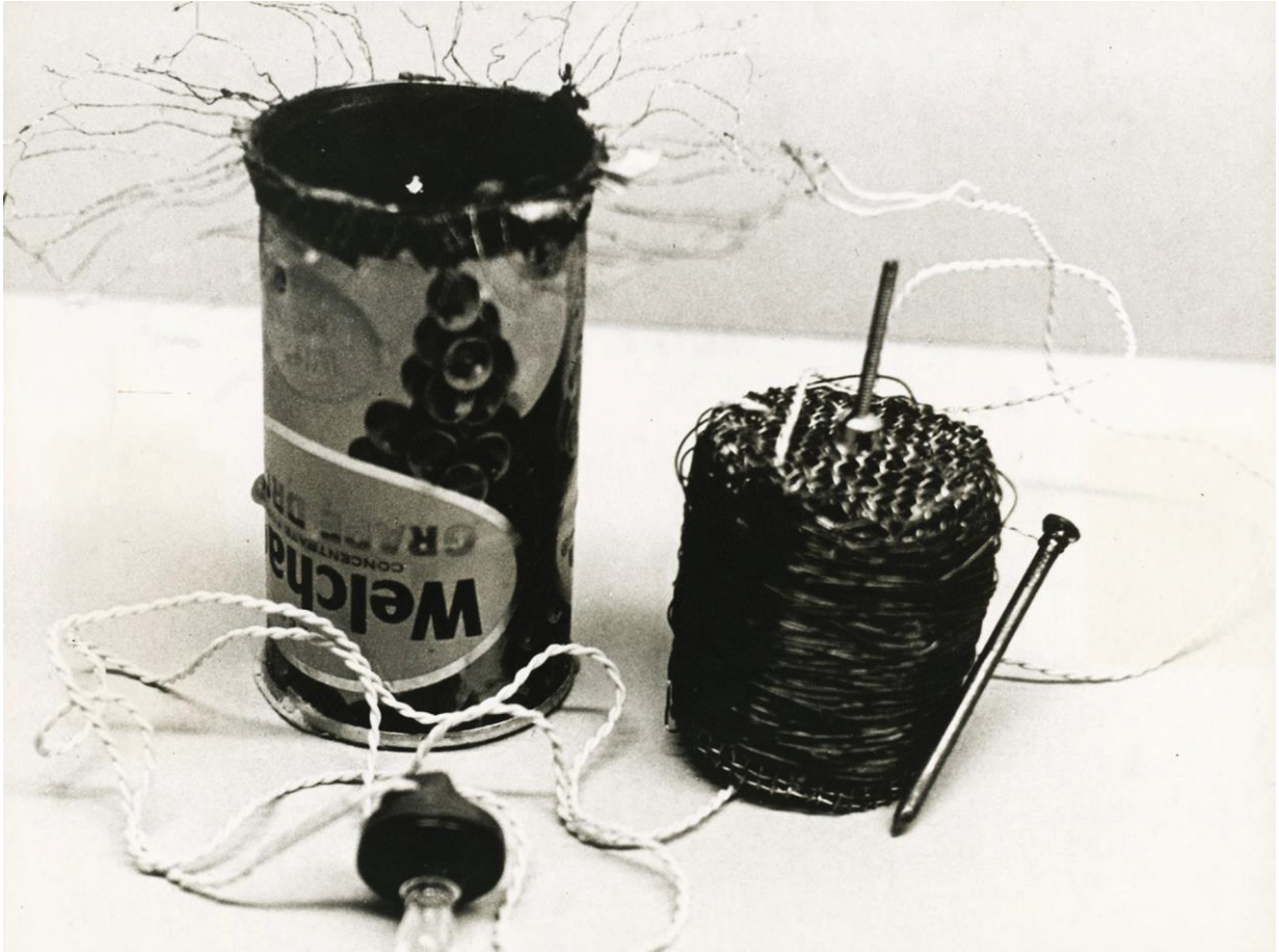
Figura 52 - Rádio projetado por Papanek por meio de uma lata, cera de parafina e esterco de vaca. Fonte: https://underprospective.com/161
