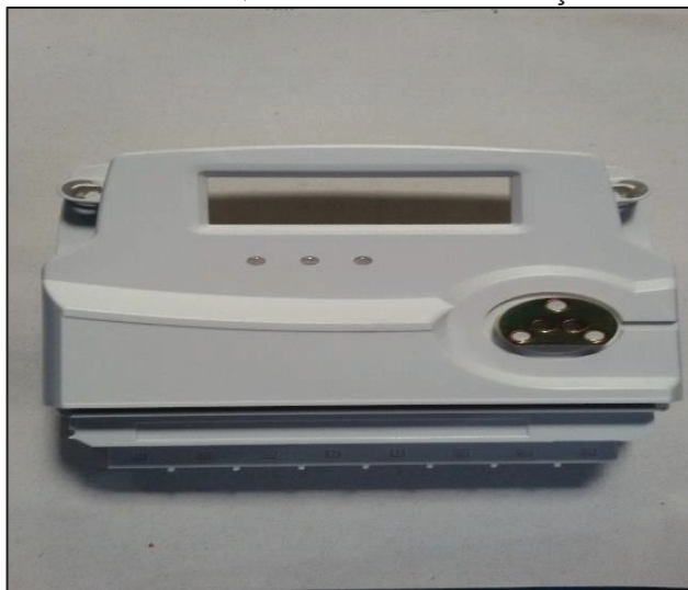
FIGURA 4: TAMPA DO EQUIPAMENTO DE MEDIÇÃO DE ENERGIA.
