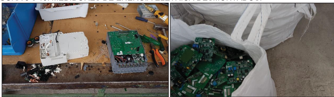
FIGURA 9 e 10: MEDIDORES DE ENERGIA ELÉTRICA DESMONTADOS.
