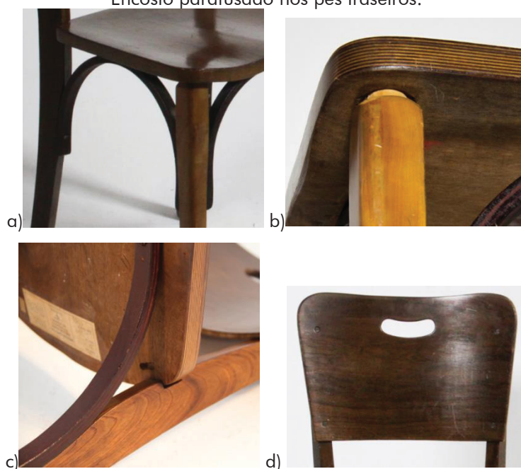
FIGURA 6 – a) Arcos curvos fixados com parafusos no assento, nos pés dianteiros e traseiros; b) Encaixe espiga dos pés dianteiros fixados no assento; c) Encaixe do assento nos pés posteriores; d) Encosto parafusado nos pés traseiros.
