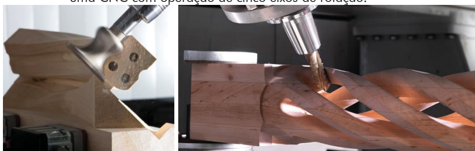
FIGURA 55 – Imagens de peças de madeira sendo usinadas com formas complexas a partir de uma CNC com operação de cinco eixos de rotação.
