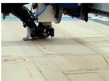
corte na madeira feito pela Router
