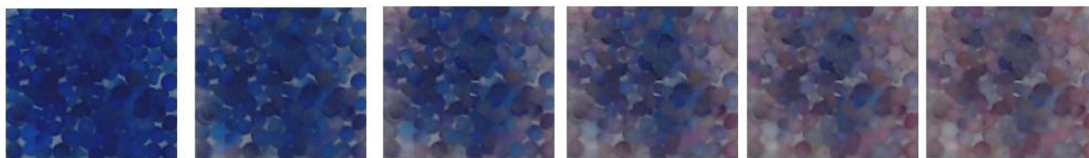
Figura 6 - Demonstração que a sílica começa absorver das bordas para o centro
