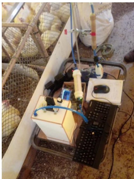
Figura 22 - Aviário situado em Palotina pertencente a UFPR onde pode ser observado o MK1 operando a aquisição das imagens.
