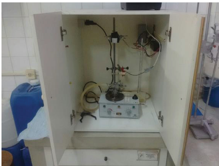
Figura 8. Foto representativa da caixa utilizada para reações de oxidação na presença de radiação luminosa (65 cm de altura, 55 cm de largura, e 55 cm de profundidade).
