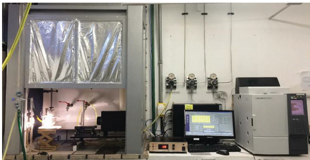
Figura 10. Foto do sistema utilizado para os experimentos de produção de hidrogênio. A esquerda no interior da capela encontra-se o simulador solar, e em frente a ele o reator de quartzo sendo iluminado. No lado direito pode ser visto o cromatógrafo utilizado para a quantificação do gás hidrogênio produzido. As estruturas representadas nas figuras estão localizadas no Laboratório de Materiais Inorgânicos, LMI, do Departamento de Química da UFSM e gentilmente disponibilizada pelo Prof. Ernesto S. Lang.
