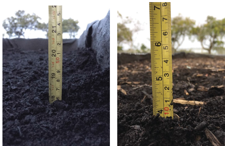
FIGURA 12- ALTURA DA CAMADA DE SUBSTRATO - TELHADO VERDE INTENSIVO X EXTENSIVO
