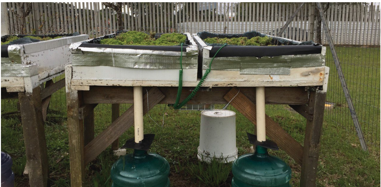
FIGURA 19- DATALOGGER INSTALADO NOS PROTÓTIPOS DE TELHADO VERDE EXTENSIVO
