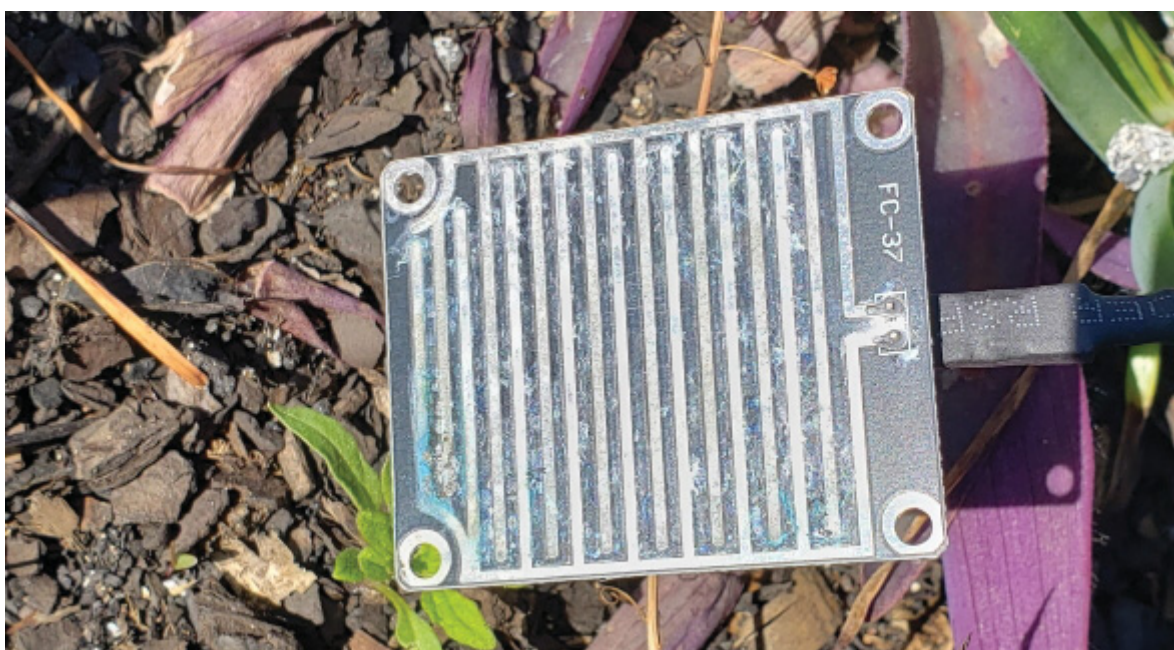
FIGURA 53 - SENSOR DE CHUVA OXIDADO
