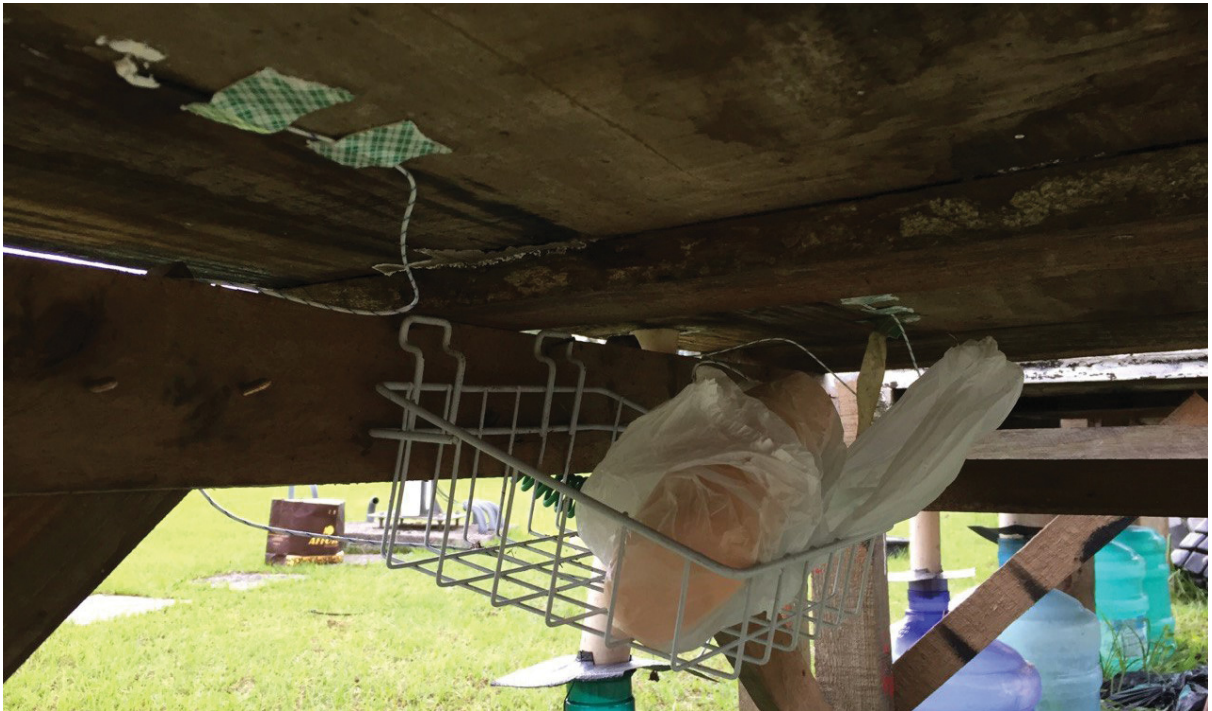
FIGURA 18- TERMOPARES FIXADOS NOS PROTÓTIPOS PARA MEDIÇÃO DA TEMPERATURA SUPERFICIAL INFERIOR
