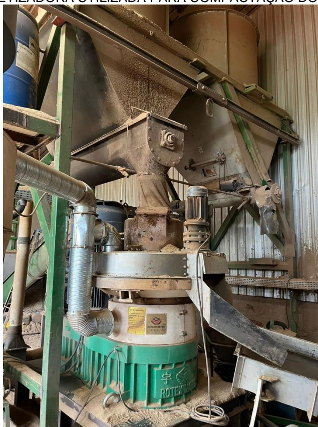
FIGURA 13 – PELETIZADORA UTILIZADA PARA COMPACTAÇÃO DO MATERIAL
