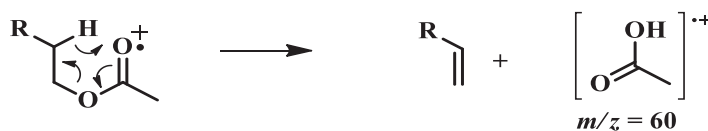
ESQUEMA 1- Rearranjo de McLafferty resultando no fragmento com m/z 60 (PAVIA, et al , 2010)
