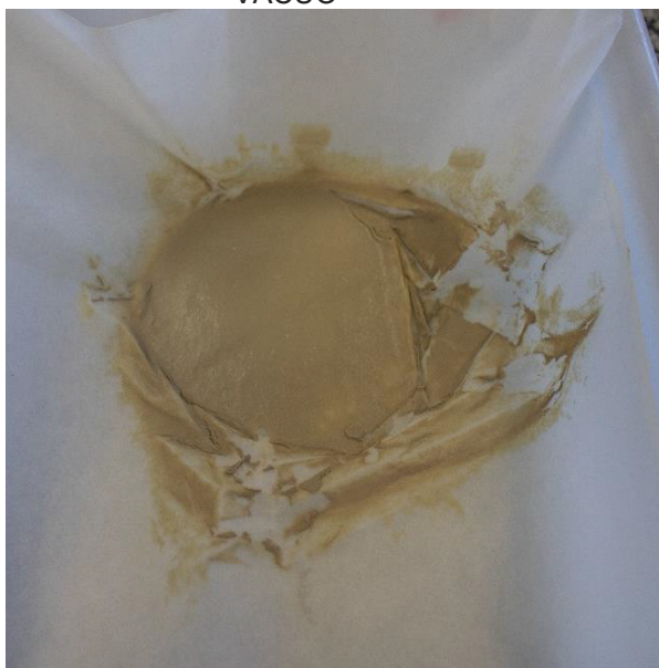
FIGURA 13 – QUERATINA RETIDA NO FILTRO DE PAPEL APÓS ETAPA DE FILTRAÇÃO A VÁCUO
