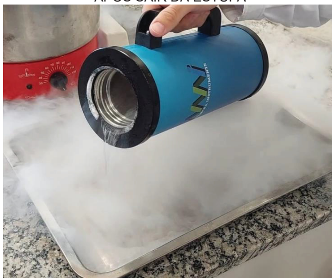
FIGURA 19 – PROCESSO DE CHOQUE TÉRMICO COM NITROGÊNIO LÍQUIDO NA QUERATINA, APÓS SAIR DA ESTUFA
