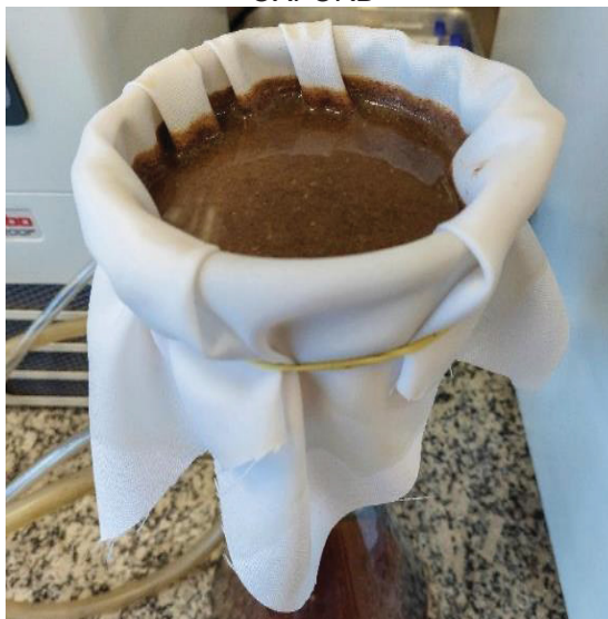
FIGURA 16 – FILTRAÇÃO A VÁCUO DO RESÍDUO INSOLÚVEL UTILIZANDO FILTRO DE TECIDO OXFORD
