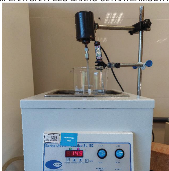
FIGURA 15 – ETAPA DE EXTRAÇÃO ALCALINA COM AGITAÇÃO MECÂNICA E CONTROLE DE TEMPERATURA PELO BANHO ULTRATERMOSTÁTICO
