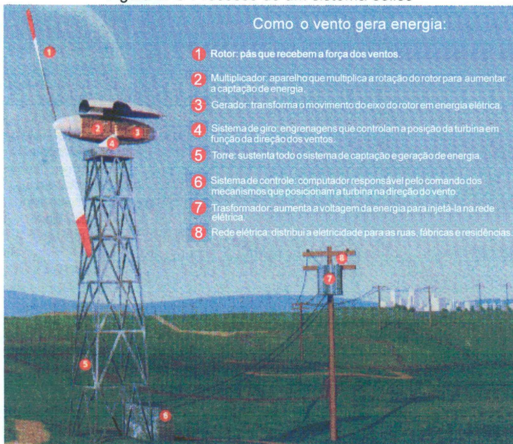
Figura 8: O Processo de um sistema eólico
