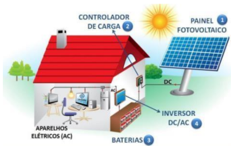
FIGURA 7 - EXEMPLO DE FUNCIONAMENTO DE GERAÇÃO OFF-GRID.
