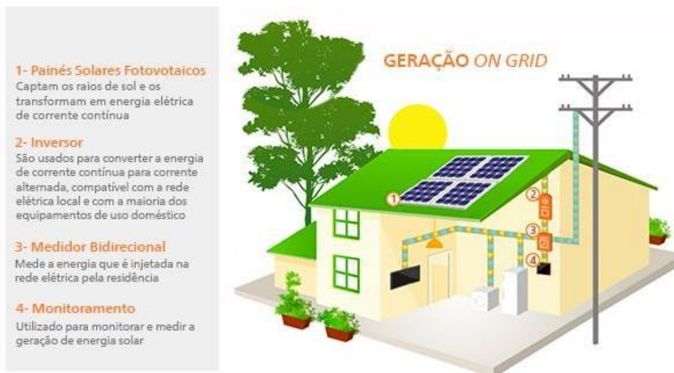
FIGURA 6 - EXEMPLO DE FUNCIONAMENTO DE GERAÇÃO ON-GRID .
