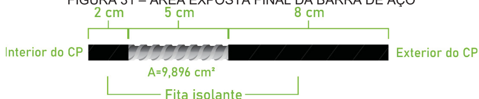
FIGURA 31 – ÁREA EXPOSTA FINAL DA BARRA DE AÇO
