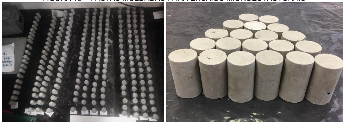
FIGURA 19 – PASTAS MOLDADAS PARA ENSAIOS MICROESTRUTURAIS
