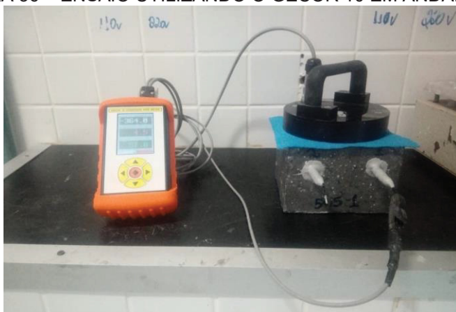
FIGURA 36 – ENSAIO UTILIZANDO O GECOR 10 EM ANDAMENTO
