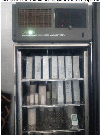
FIGURA 25 – CÂMARA DE CARBONATAÇÃO ACELERADA
