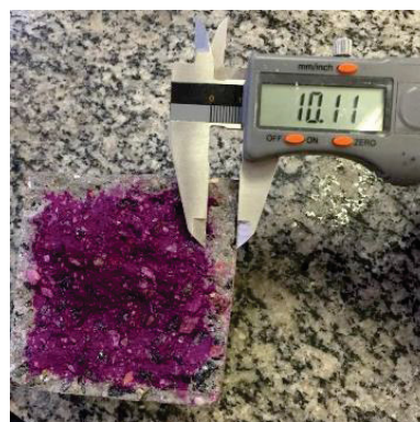
d) Leitura da frente carbonatada
