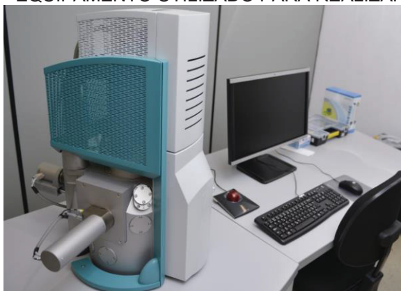
FIGURA 21 – EQUIPAMENTO UTILIZADO PARA REALIZAR MEV E EDS
