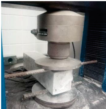
a) Fatiamento no eixo transversal do corpo de prova
