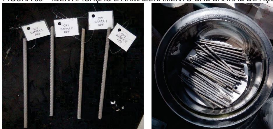
FIGURA 30 – IDENTIFICAÇÃO E ARMAZENAMENTO DAS BARRAS DE AÇO
