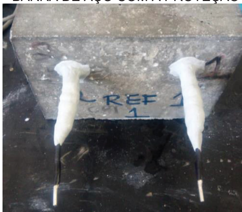
FIGURA 34 – BARRA DE AÇO COM A PROTEÇÃO FINALIZADA
