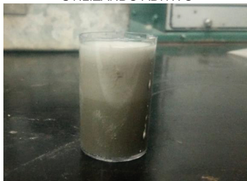
FIGURA 18 – AMOSTRA DE PASTA SEGREGADA APÓS MISTURA EM ARGAMASSADEIRA UTILIZANDO ADITIVO
