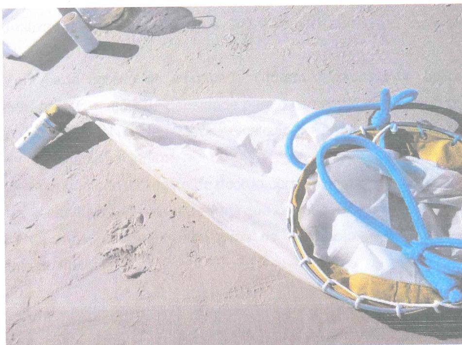
Figura 2: Rede de plâncton cilindro cônica utilizada durante as coletas
