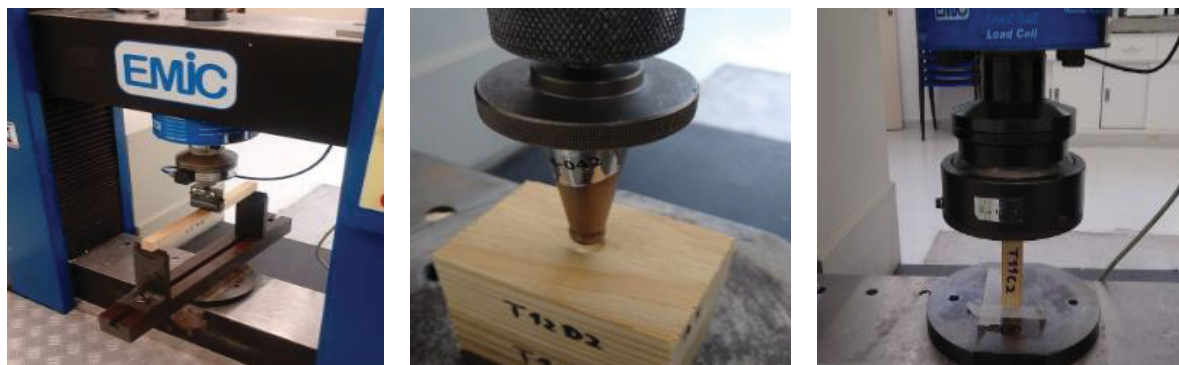
FIGURA 13 – ENSAIOS MECÂNICOS DE FLEXÃO ESTÁTICA, COMPRESSÃO PARALELA ÀS FIBRAS E DUREZA JANKA
