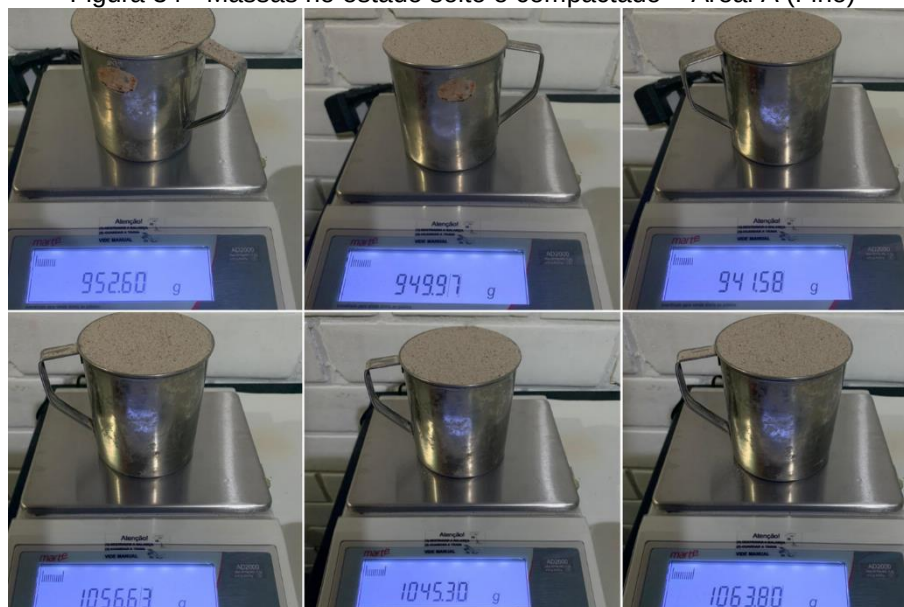
Figura 34 - Massas no estado solto e compactado – Areal A (Fino)
