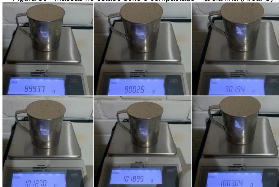
Figura 36 - Massas no estado solto e compactado – areia fina (Areal C)
