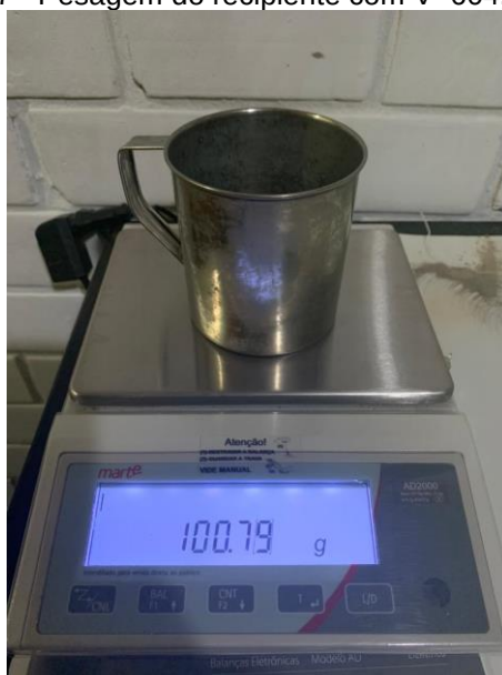
Figura 7 - Pesagem do recipiente com V=604,364cm 3
