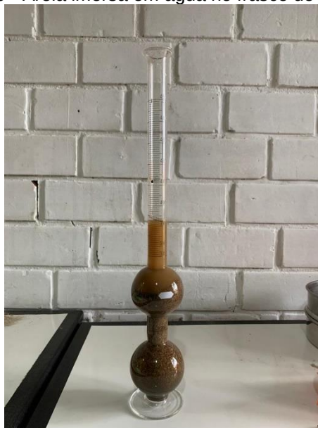
Figura 10 - Areia imersa em água no frasco de Chapman
