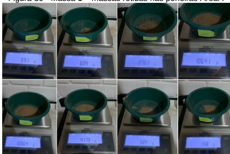
Figura 30 - Massa 1 – massas retidas nas peneiras Areal F
