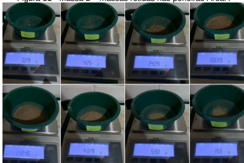
Figura 31 - Massa 2 – massas retidas nas peneiras Areal F
