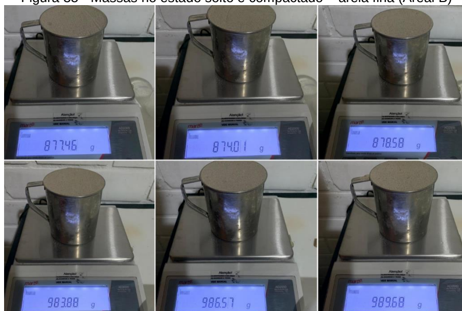
Figura 35 - Massas no estado solto e compactado – areia fina (Areal B)
