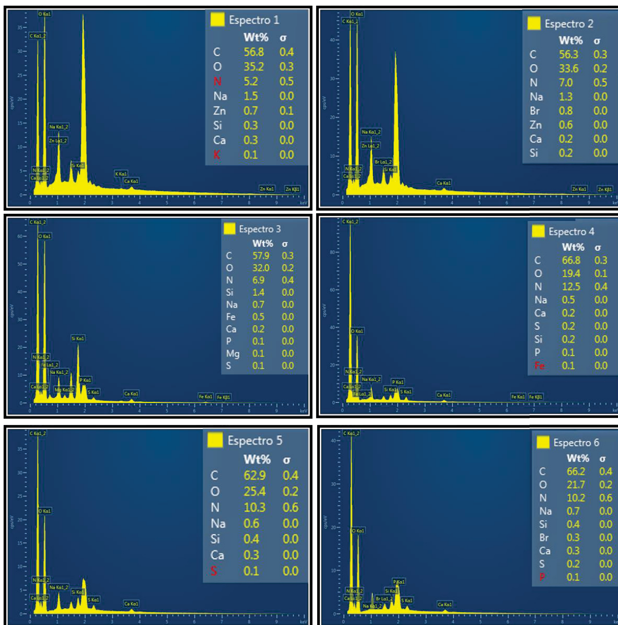
FIGURA AII-2 – ESPECTROS RESULTANTES DA ANÁLISE DA AMOSTRA DO 319° DIA DE OPERAÇÃO DO RanLFb1 COM ARS
