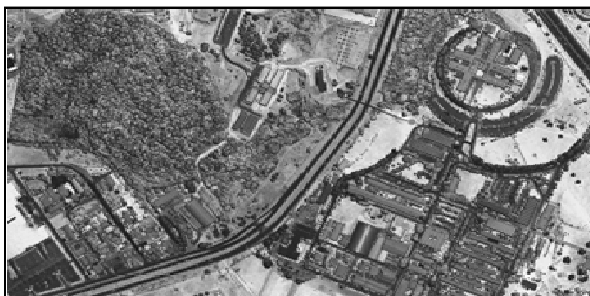
FIGURA 2.22 - IMAGEM GERADA A PARTIR DA INTENSIDADE DE RETORNO DO PULSO LASER
