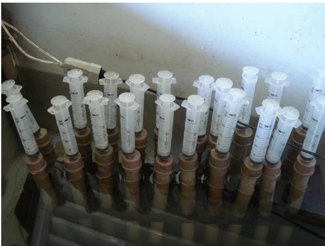
Figura 1. Condução dos ensaios utilizando reatores em estufa de banho d'água
