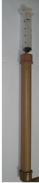
Figura 2. Biorreator laboratorial construído para os ensaios de biodigestão anaeróbia
