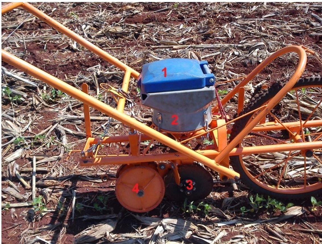
FIGURA 1. EQUIPAMENTO MANUAL PARA PLANTIO DE SOJA. ONDE: 1- CAIXA DE SEMENTES; 2- DISCO ALVEOLADO; 3- DISCO SULCADOR; 4- COMPACTADOR.
