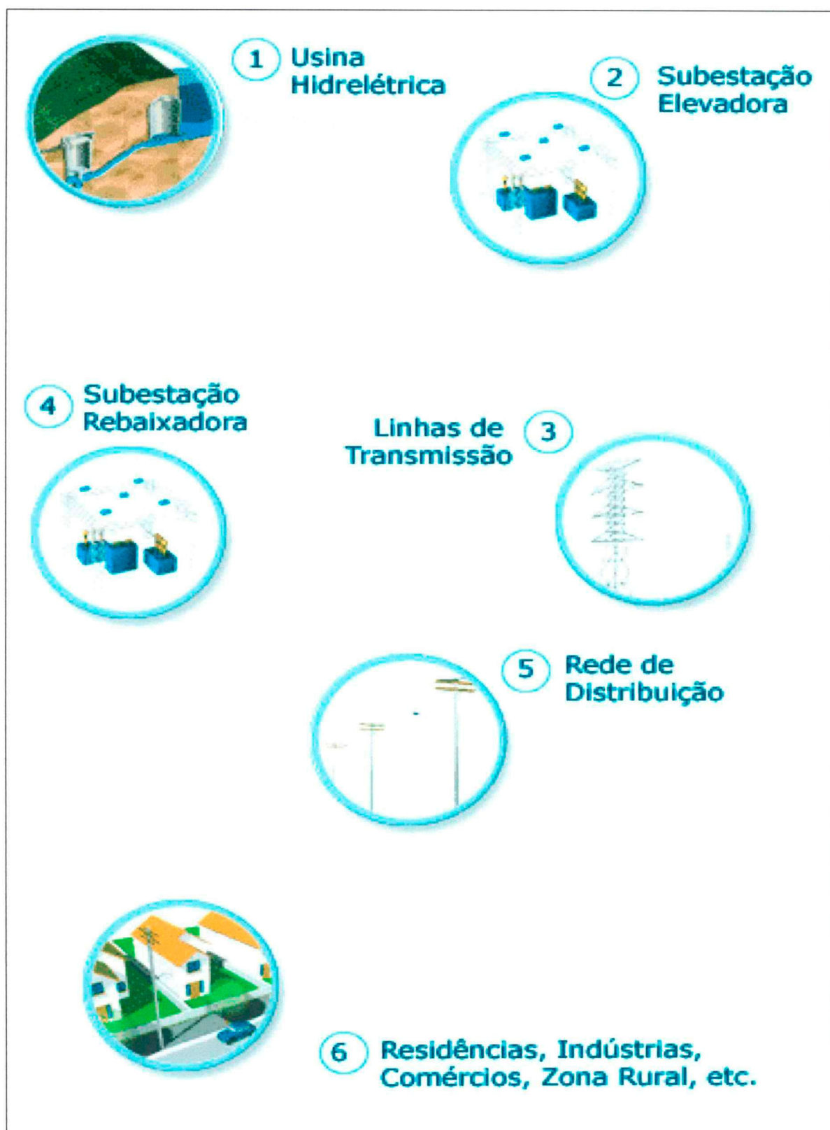
Figura 04: Sistema de geração, transmissão e distribuição.
