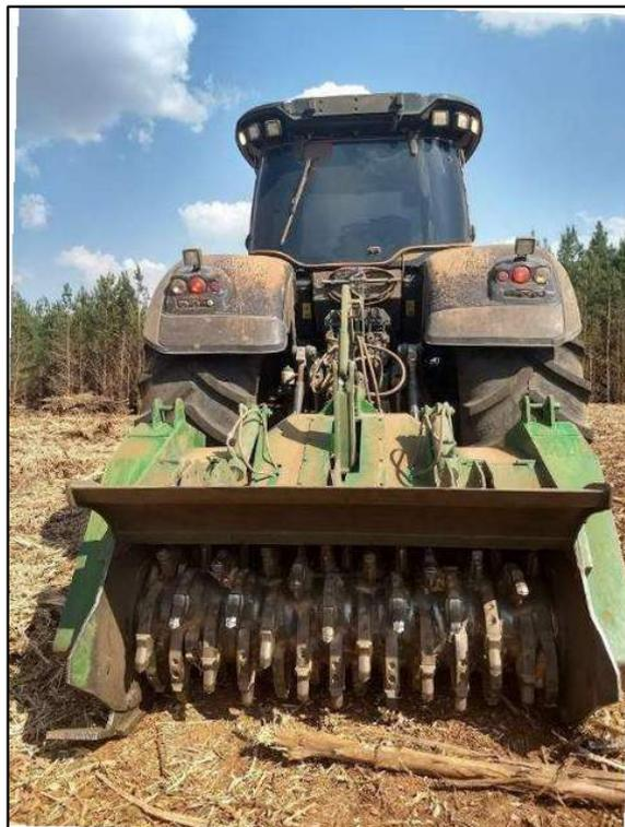
**Figura 4:** Cabeçote triturador FAE. Telêmaco Borba, 2017. Fonte: A autora.
