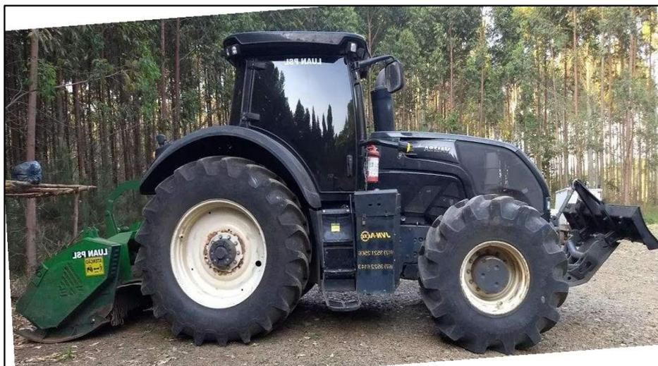
**Figura 3:** Trator Valtra com cabeçote FAE acoplado na traseira. Telêmaco Borba, 2017. Fonte: A autora.
