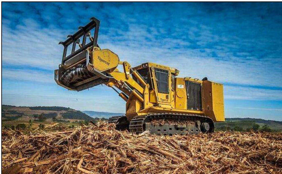
**Figura 5:** Triturador Mulcher 480B. Telêmaco Borba, 2018. Fonte: A autora.
