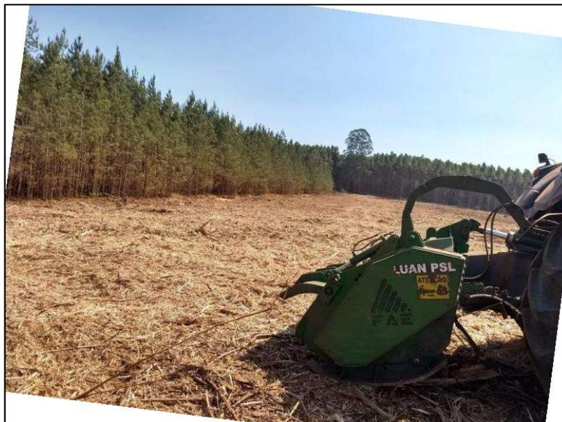
**Figura 8:** Resultado do resíduo triturado pelo cabeçote FAE. Telêmaco Borba, 2017. Fonte: A autora.
