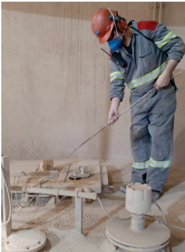
Figura 3. Método de medição por corda. (O autor,2020).
