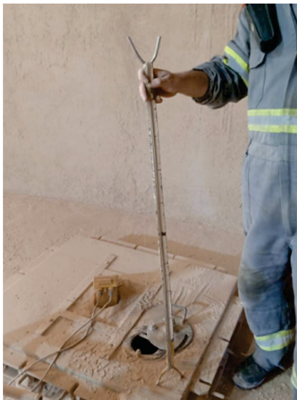
Figura 4. Gabarito do Método de medição por corda. (O autor,2020).
