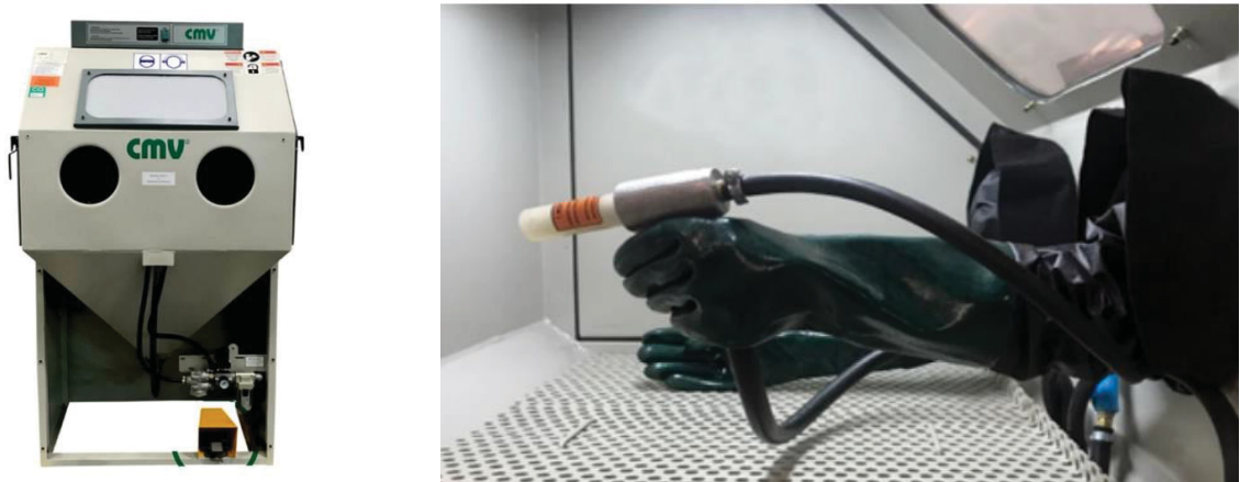
FIGURA 15: GABINETE DE JATEAMENTO UTILIZADO TAMBÉM PARA SHOT PEENING . À ESQUERDA, VISÃO EXTERNA E, À DIREITA, VISÃO INTERNA DO EQUIPAMENTO.
