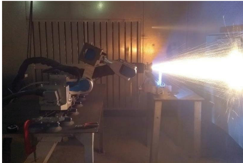
FIGURA 19: APLICAÇÃO ROBOTIZADA DOS REVESTIMENTOS.
