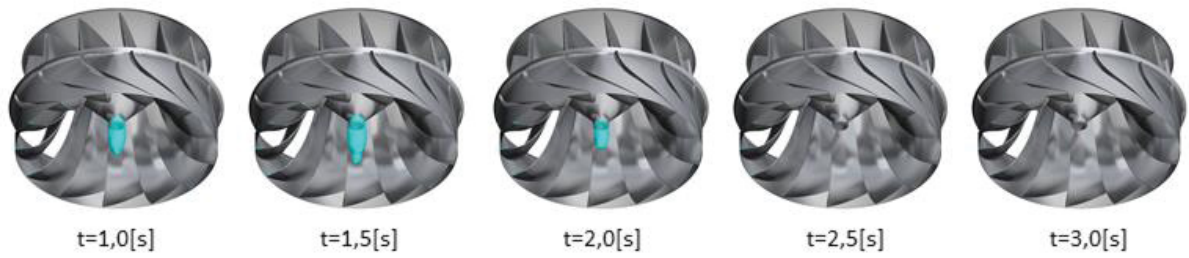
FIGURA 22 - DESAPARECIMENTO DO VÓRTICE DE ALTA CARGA DURANTE A MUDANÇA DE CONDIÇÃO DE OPERAÇÃO.
