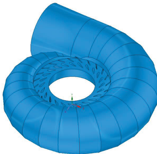
FIGURA 8 – MODELO GEOMÉTRICO DA REGIÃO DE FLUIDO DO CONJUNTO CAIXA ESPIRAL, PRÉ-DISTRIBUIDOR E DISTRIBUIDOR.
