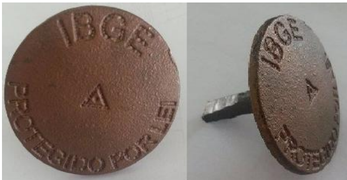
FIGURA 4. PINO METÁLICO UTILIZADO NO MARCO.
