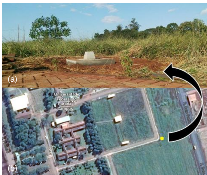
FIGURA 2. (A) VISTA PANORÂMICA DO MARCO MATERIALIZADO. (B) IMAGEM AÉREA DA ÁREA ONDE FOI IMPLANTADO O MARCO GEODÉSICO, COM DETALHE EM AMARELO PARA A LOCALIZAÇÃO EXATA DO MESMO.
