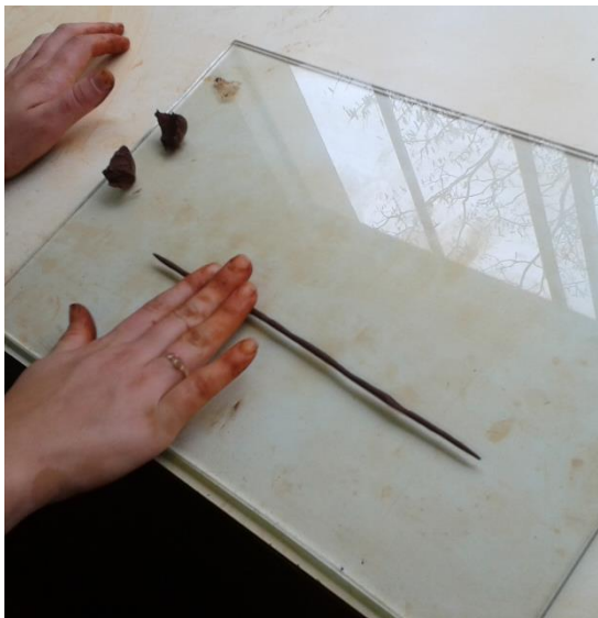
FIGURA 3: DETERMINAÇÃO DO LIMITE DE PLASTICIDADE. FONTE: AUTOR
