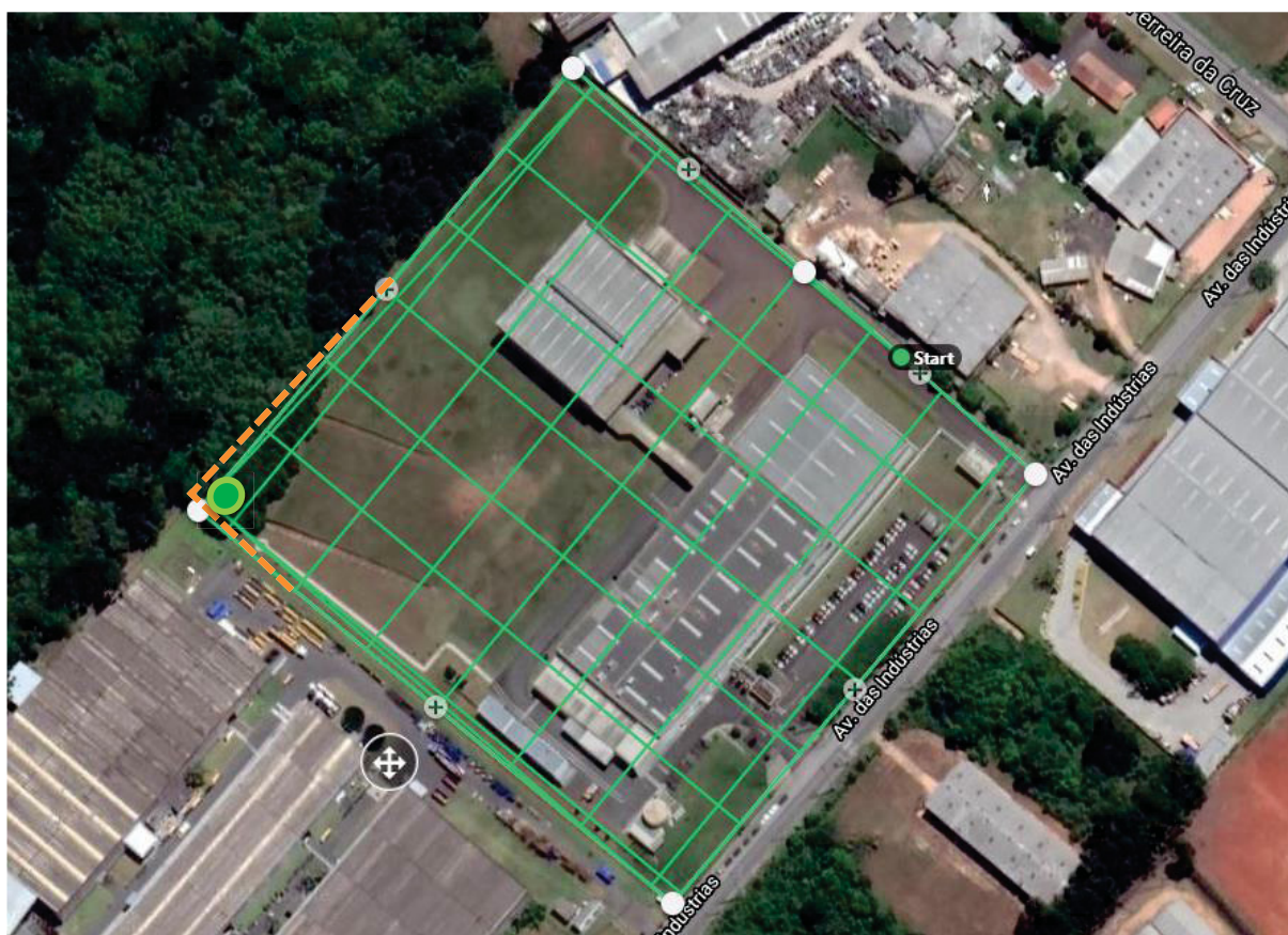
Figura 17 – Plano de voo no DroneDeploy®
