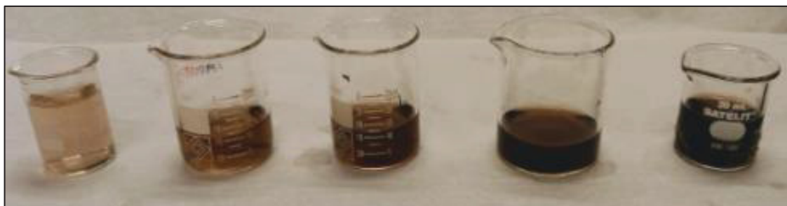
FIGURA 26 – DIFERENTES COLORAÇÕES PARA CONCENTRAÇÕES DIFERENTES DA SOLUÇÃO PADRÃO DE CHUMBO
