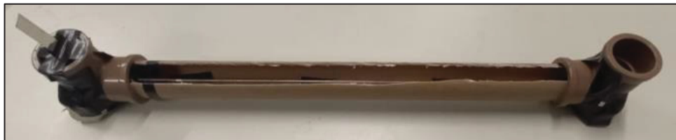
FIGURA 12 – CÉLULA ELETROQUÍMICA PARA A ANODIZAÇÃO
