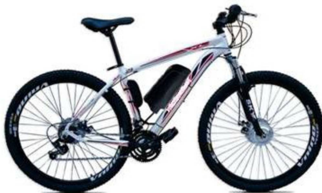
FIGURA 2. Bicicleta com kit instalado (motor, controlador, bateria e acelerador).
