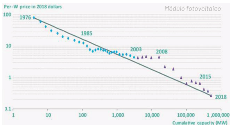
FIGURA 8 – PREÇO U$/W DE MÓDULOS FOTOVOLTAICOS
