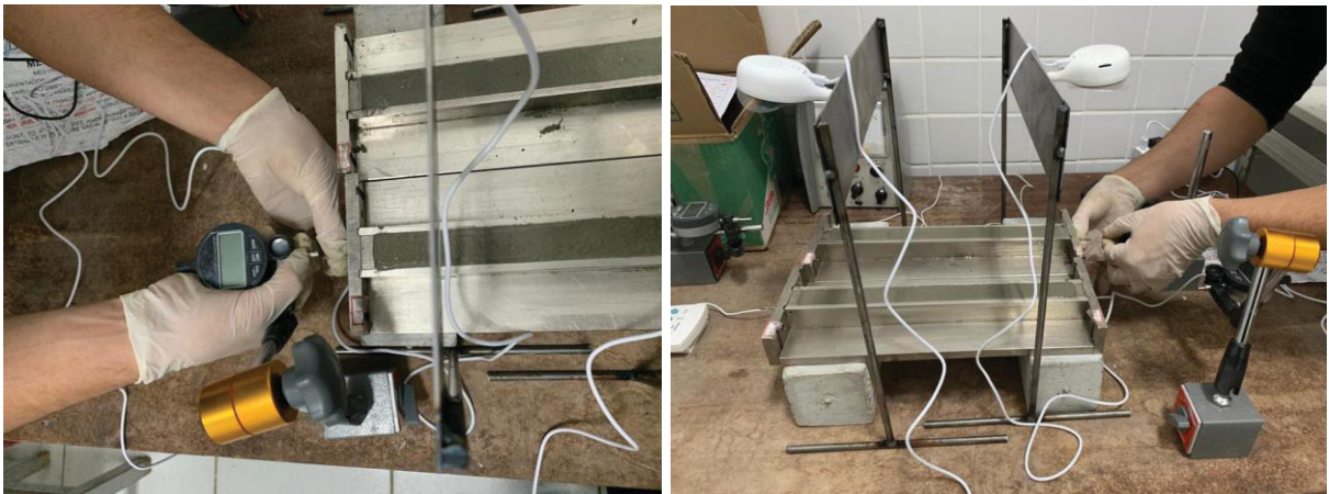
FIGURA 35 – ROSQUEAMENTO DOS CONECTORES COM OS RELÓGIOS
