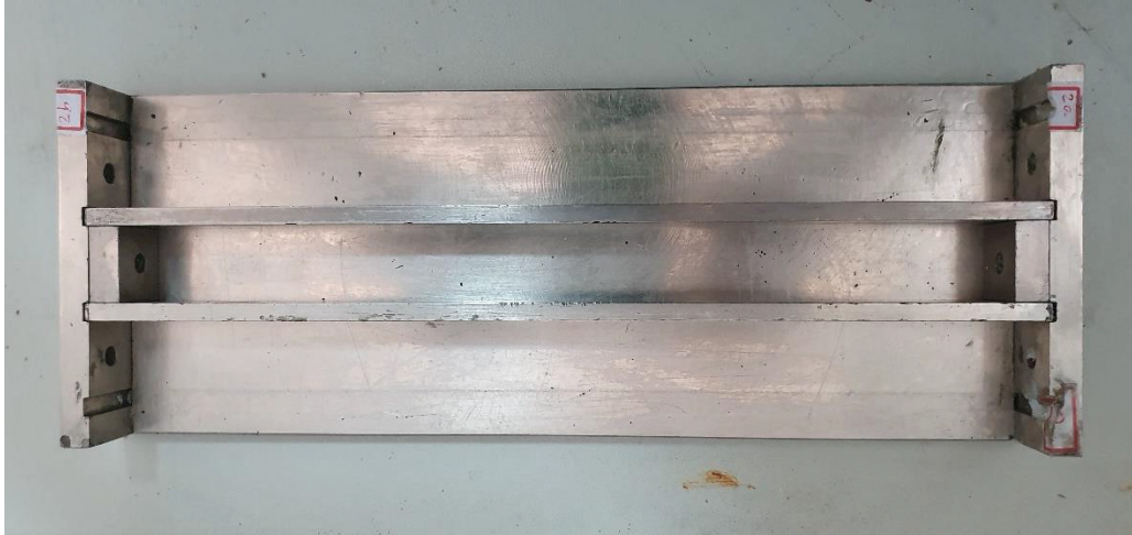
FIGURA 16 – MOLDE DA NBR 15261 UTILIZADO NO MÉTODO PROPOSTO
