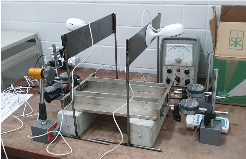
FIGURA 36 – CAMÊRAS POSICIONADAS SOBRE OS RELÓGIOS, ENSAIO PRONTO PARA O INÍCIO DAS LEITURAS
