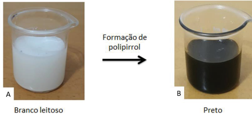
FIGURA 23 - MUDANÇA DE COR DO MEIO REACIONAL, DE BRANCO LEITOSO A PRETO: A) ANTES DA ADIÇÃO DO AGENTE OXIDANTE E B) APÓS O FINAL DA REAÇÃO, INDICANDO A FORMAÇÃO DO POLIPIRROL.
