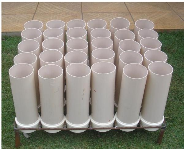
FIGURA 3. CAVALETE PARA ALOCAÇÃO DAS COLUNAS DE SOLO.
