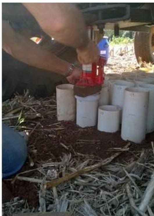
FIGURA 1. UTILIZAÇÃO DO MACACO HIDRÁULICO E TRATOR PARA INSERÇÃO DAS COLUNAS AO SOLO.
