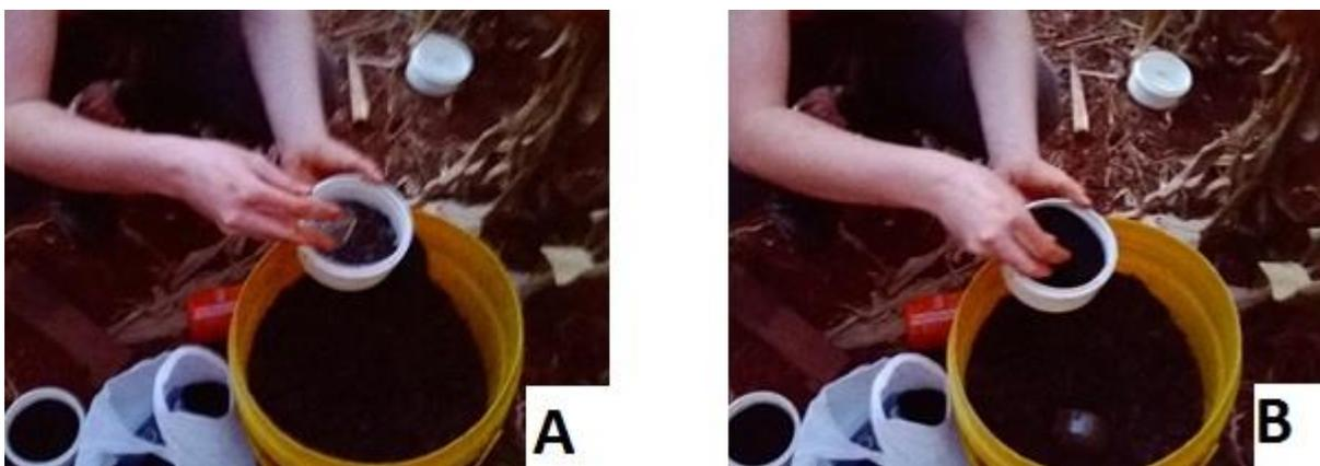
FIGURA 2. PREENCHIMENTO DO CAP COM PEDRISCO (A) E COM CARPETE (B).
