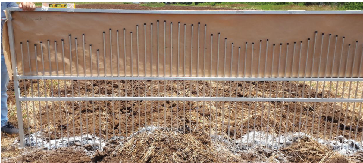
FIGURA 30 - MARCAÇÕES DO PERFIL MOBILIZADO DO SOLO – (A) CONVENCIONAL (B) ELETRÔNICO
