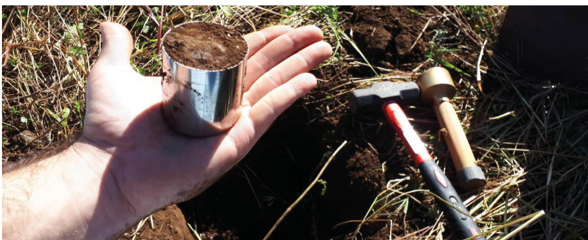
FIGURA 17 - COLETA DE AMOSTRAS INDEFORMADAS DE SOLO PARA DENSIDADE
