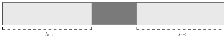
FIGURA 10 – REPRESENTAÇÃO DA DISTRIBUIÇÃO DE PEÇAS EM UM CANTEIRO DE LARGURA 2n ONDE NÃO SEJA VIÁVEL SEPARAR AO MEIO
