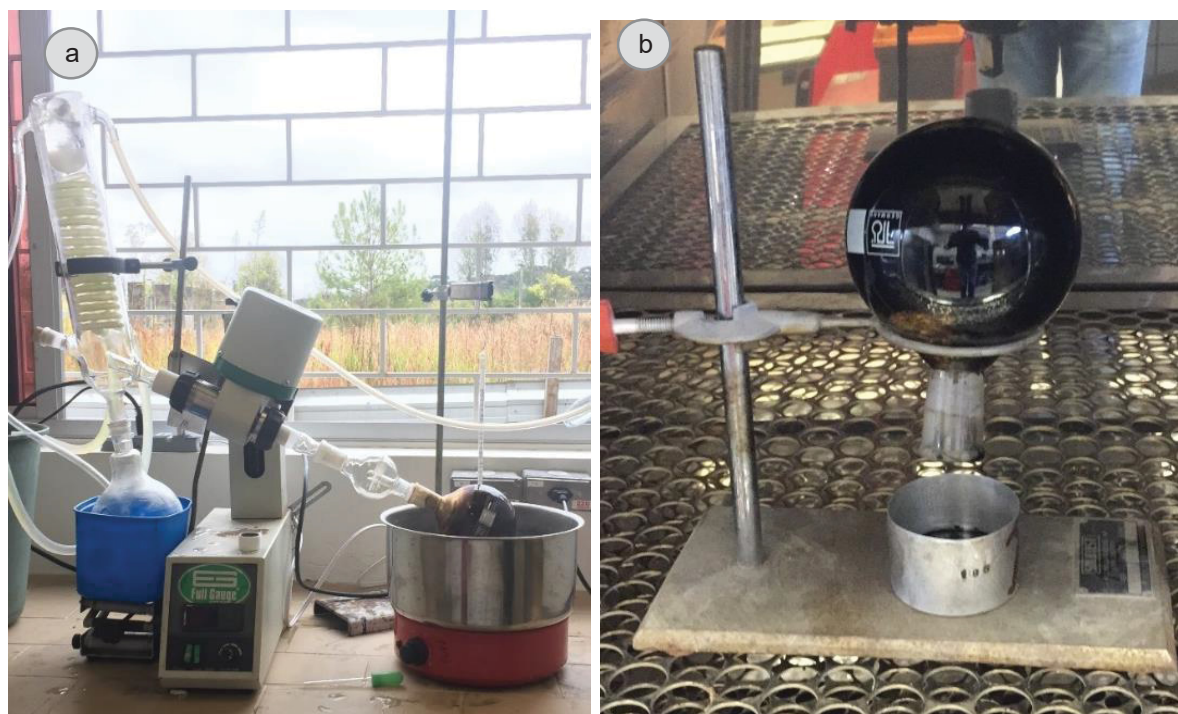
Figura 28 - (a) Rotaevaporador do LaPPS em funcionamento e (b) escoamento do ligante do balão.
