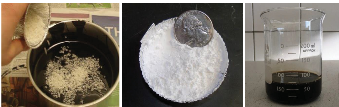
Figura 16 - Aditivos para produção de misturas mornas. (a) cera orgânica (b) zeólitas para produção de asfalto-espuma e (c) aditivo surfactante.
