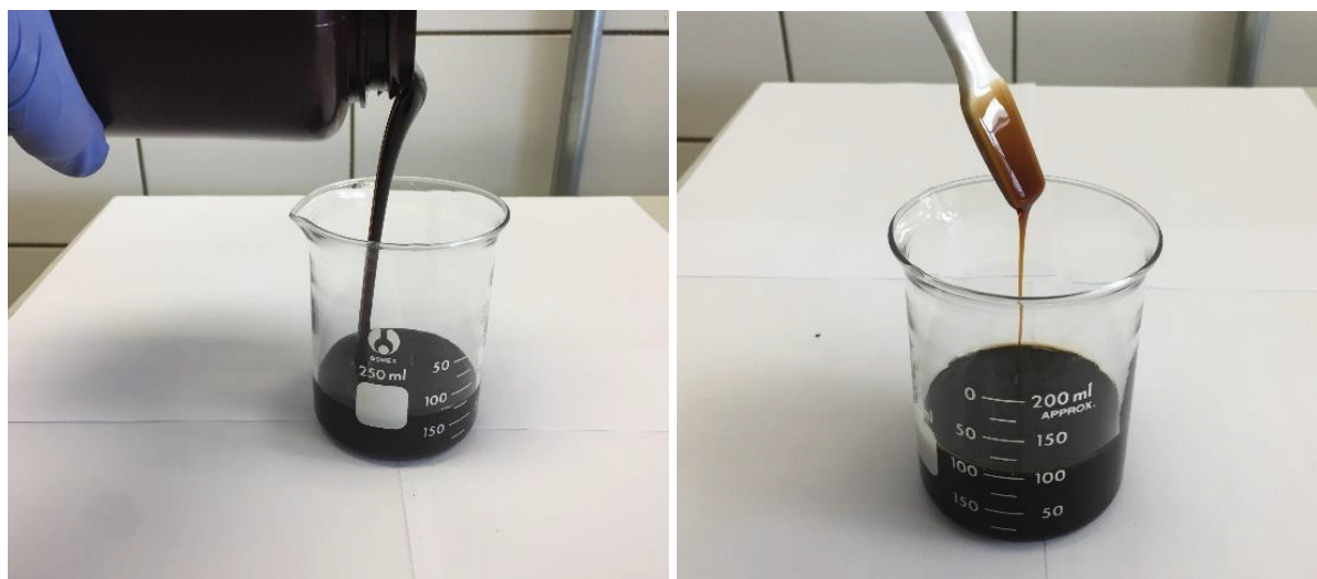
Figura 25 - Consistência do aditivo surfactante para misturas mornas.
