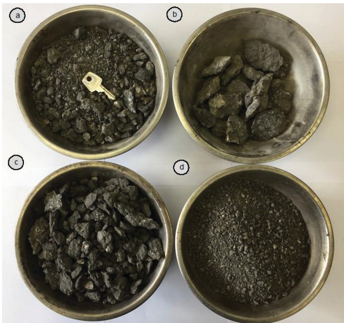
Figura 27 - Aspecto da granulometria do material fresado sendo (a) o fresado original; (b) a fração retida na peneira #25mm e descartada; (c) a fração graúda retida na #4; e (d) a fração miúda, passante na #4.
