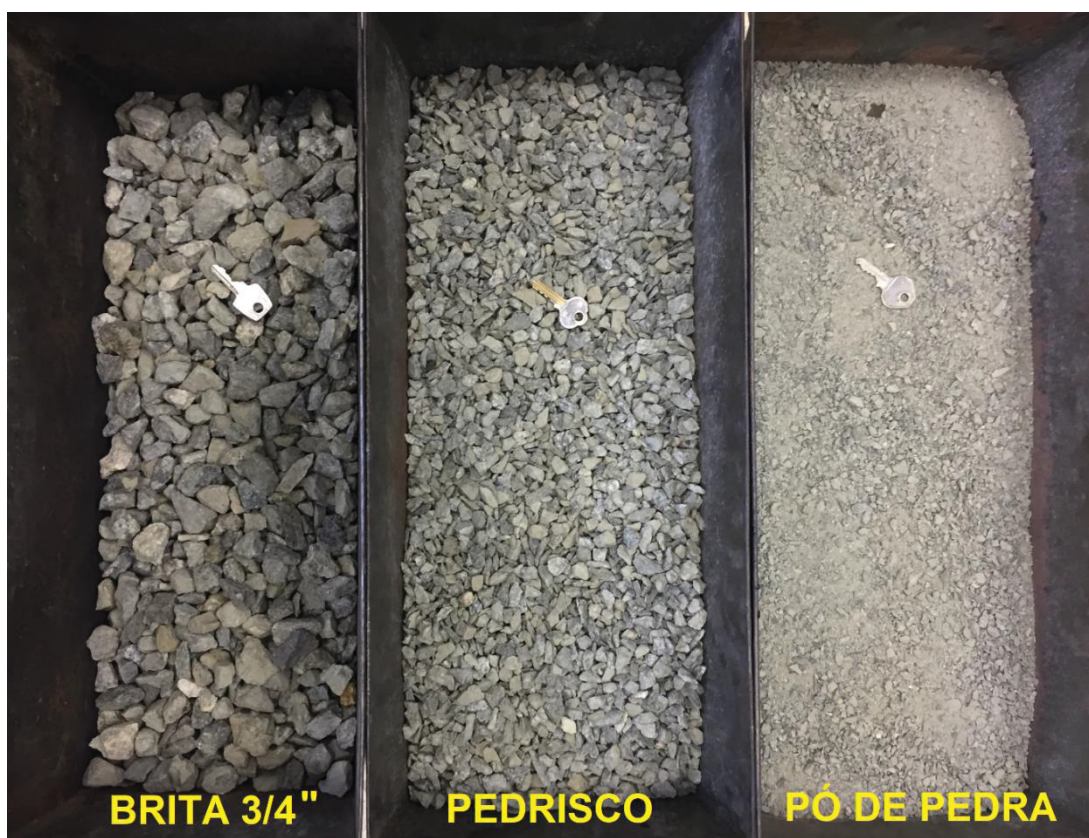
Figura 22 - Aparência dos agregados virgens utilizados na pesquisa.
