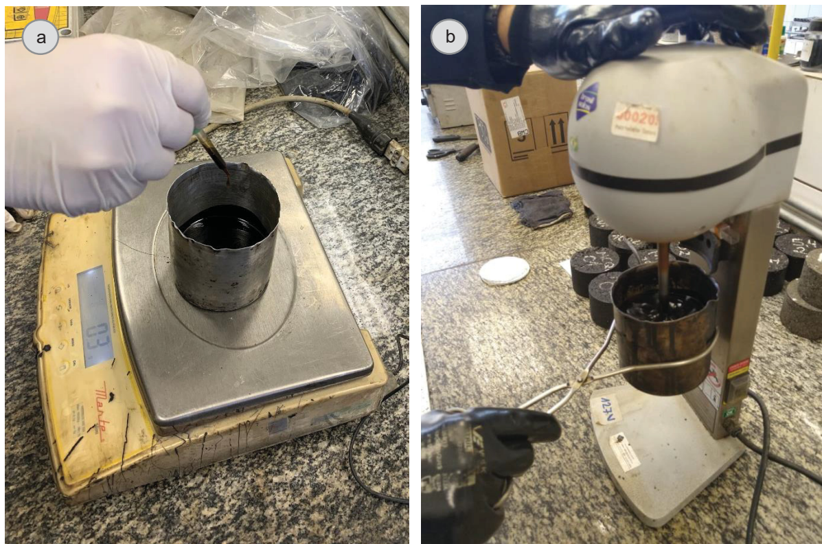
Figura 32 - Procedimento de (a) dosagem com pipeta e (b) mistura do aditivo surfactante para misturas mornas no ligante virgem.
