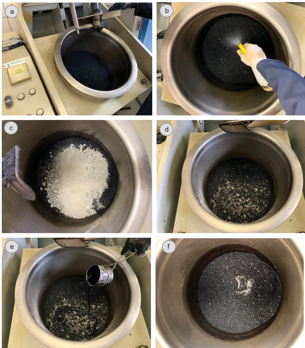
Figura 31 - (a) Aquecimento do RAP na panela; (b) adição do AR no RAP com spray e mistura por 60s; (c) adição do agregado virgem aquecido; (d) mistura do RAP com o agregado virgem por 60s; (e) adição do ligante virgem; (f) mistura final por 120s.
