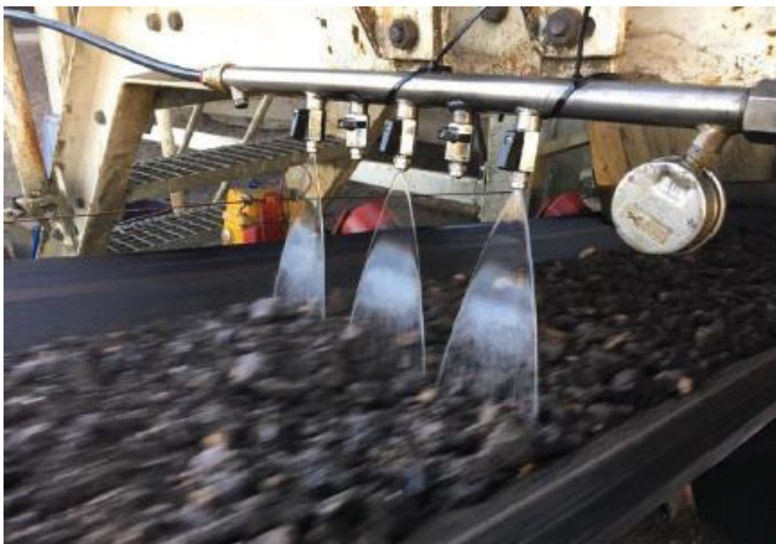
Figura 9 - Adição de AR diretamente ao RAP na esteira.
