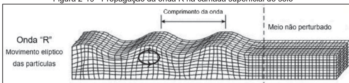
Figura 2-19 - Propagação da onda R na camada superficial do solo
