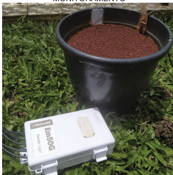
FIGURA 29 – EXEMPLO DE AMOSTRA EXPOSTA ÀS INTEMPÉRIES NO INÍCIO DO MONITORAMENTO
