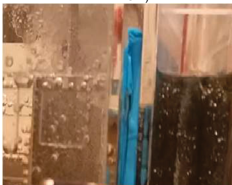
FIGURA 22 – EVOLUÇÃO DE GASES NOS ELETRODOS – HIDROGÊNIO NO CÁTODO (ESQUERDA) E OXIGÊNIO DIFUNDIDO NO ÂNODO POROSO (DIREITA) (LOCAL: TOPO DO REATOR)
