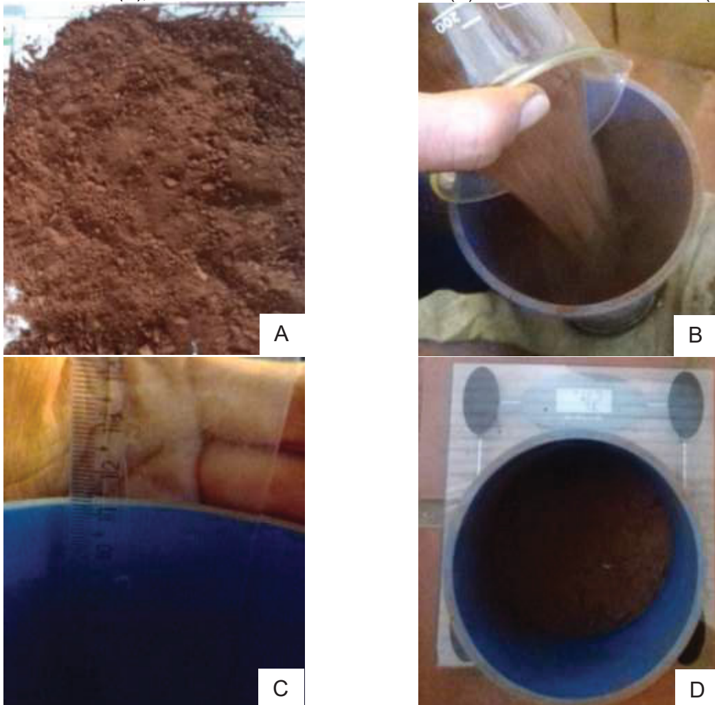
FIGURA 6. DESTORROAMENTO E SECAGEM DO SOLO (A), PREENCHIMENTO DA COLUNA COM SOLO (B), MEDIDA DA ALTURA DA COLUNA (C) E PESAGEM DA COLUNA (D)
