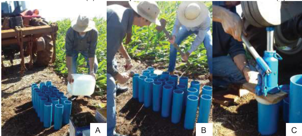
FIGURA 5. PRÉ-MOLHAMENTO E SATURAÇÃO DO SOLO (A), INTRODUÇÃO DOS TUBOS DE PVC COM MARRETA (B) E UTILIZAÇÃO DO MACACO HIDRÁULICO SOB TRATOR (C)
