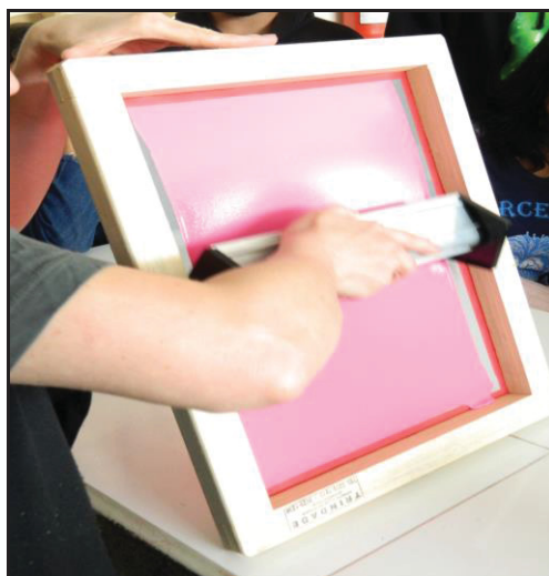
FIGURA 34 - APLICAÇÃO DA EMULSÃO
