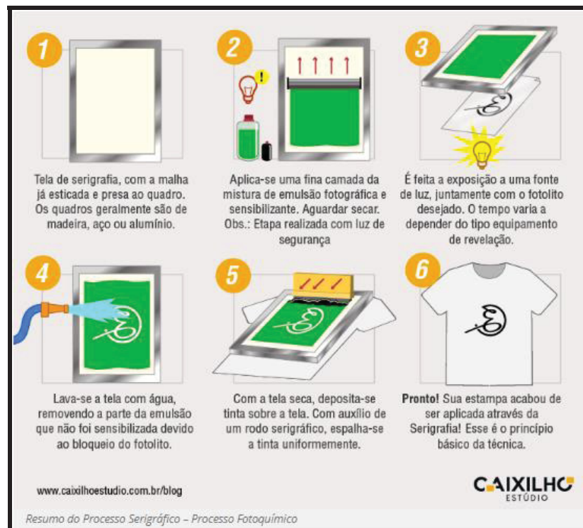
FIGURA 9 - RESUMO DO PROCESSO SERIGRÁFICO FOTOQUÍMICO
