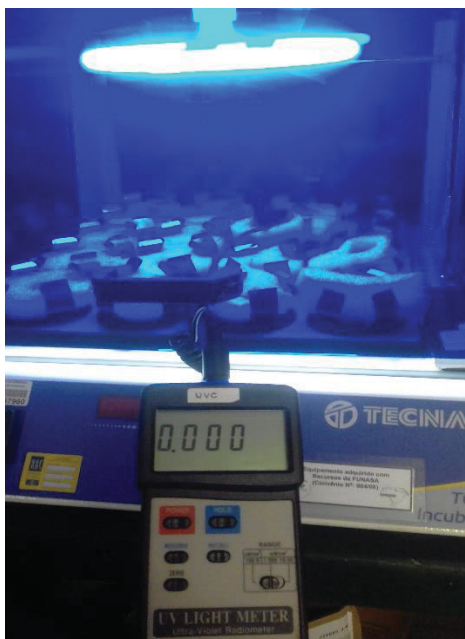
Figura 1S. Radiômetro de luz UVC, com sensor posicionado no interior da incubadora equipada com lâmpada, indicando 0 mW/cm 2 de radiação UVC.
