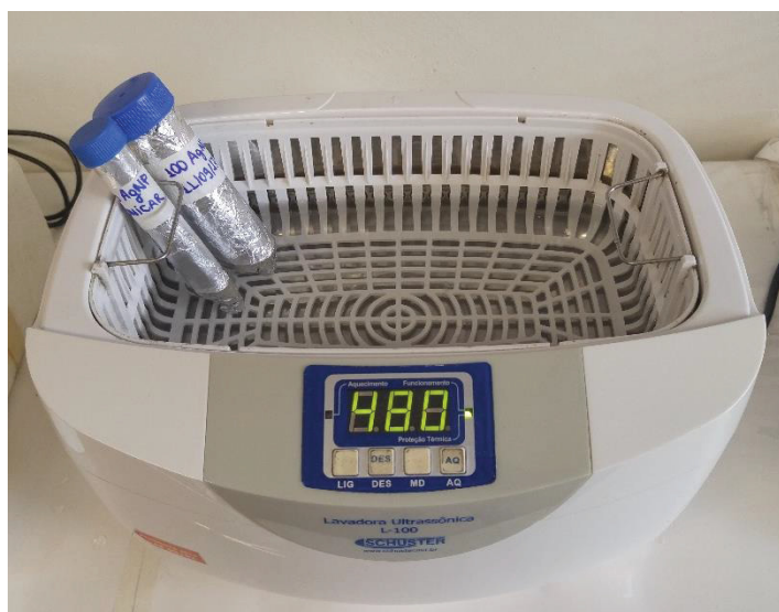
Figura 2. Desagregação de AgNP em lavadora ultrassônica antes da exposição às sementes de A. cepa .
