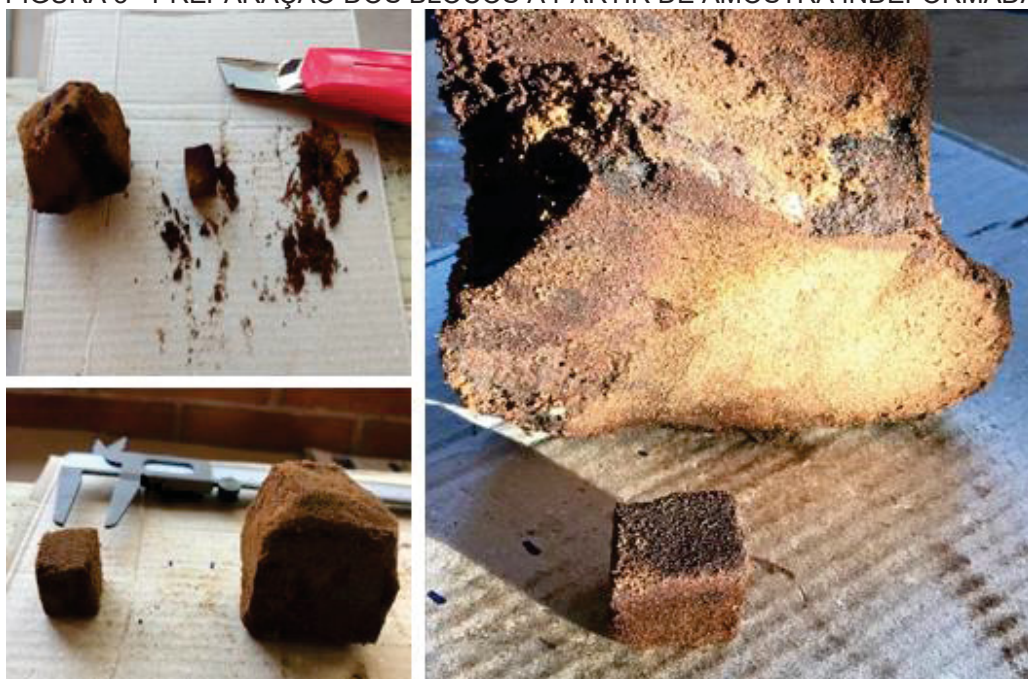
FIGURA 3 - PREPARAÇÃO DOS BLOCOS A PARTIR DE AMOSTRA INDEFORMADA
