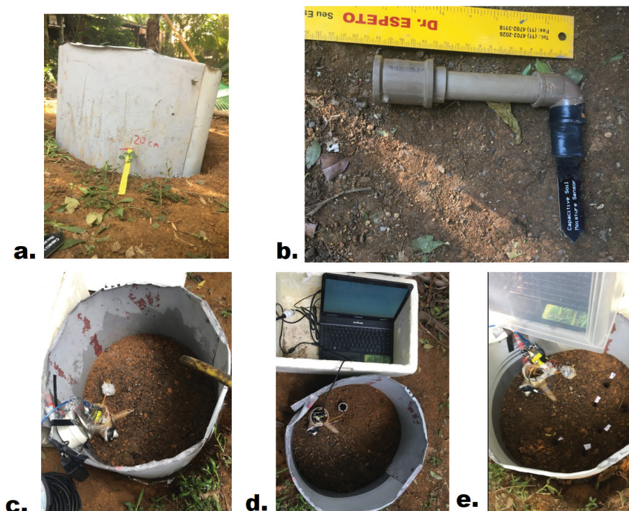
FIGURA 12 – CALIBRAÇÃO EM CAMPO DOS SENSORES DE SOLO
