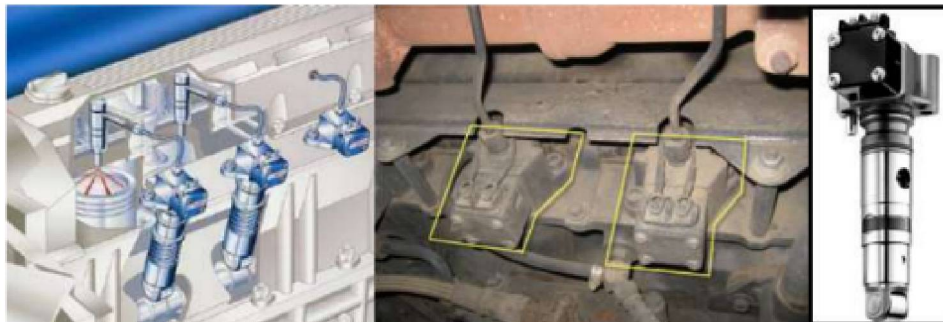
Figura 38 - Motor diesel e posicionamento da bomba unitária.
