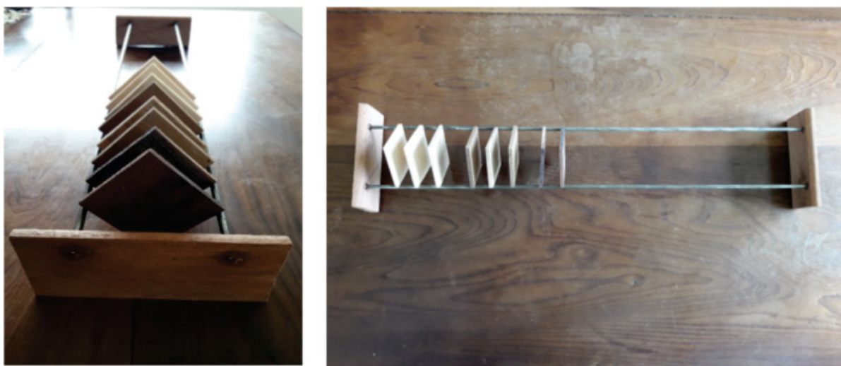
Figura 57 – Suporte para as avaliações de secagem da câmara climática
