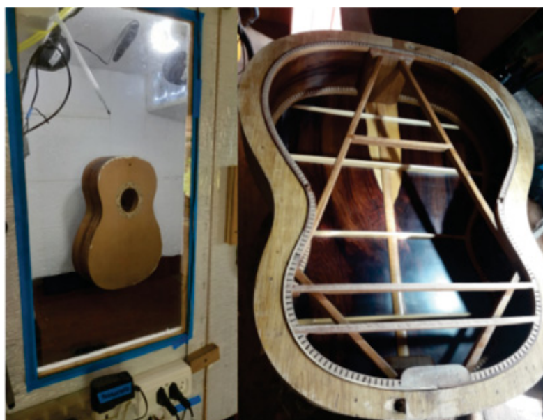
Figura 98 – Caixa acústica de violão confeccionada conforme o processo sugerido neste trabalho
