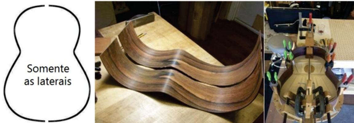
Figura 37 – Método de construção “sem fôrma”
