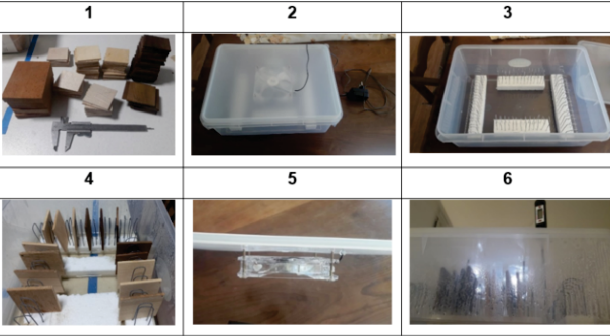
Figura 55 – Conjunto das amostras e os elementos que compões a câmara úmida
