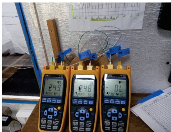
Figura 53 – Fiação dos termômetros digitais acessando a câmara climática pela abertura de acesso rápido
