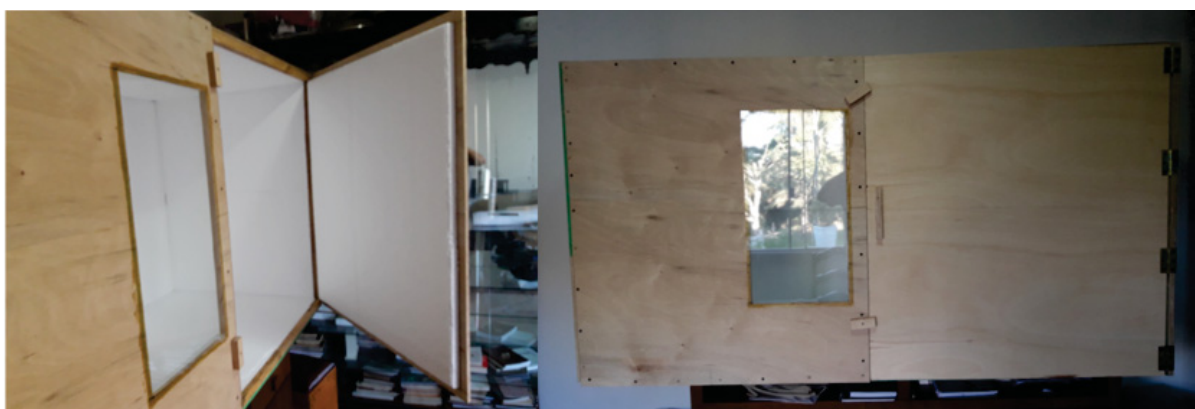
Figura 60 – Visão frontal do compartimento de aclimação com a porta de acesso concluída
